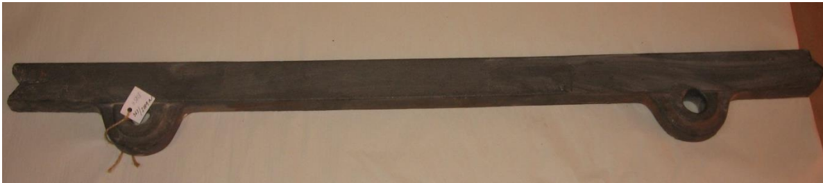
Obr.323 Kopie litinové kolejnice s nálitky opatřenými otvory k připevnění kolejnice hřeby ke kvádru
