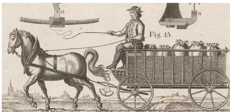
Obr.391 Nákladní vůz s dynamometrem k měření tahu koně (Lit.4) Obr. 392 Nákladní silniční vůz
