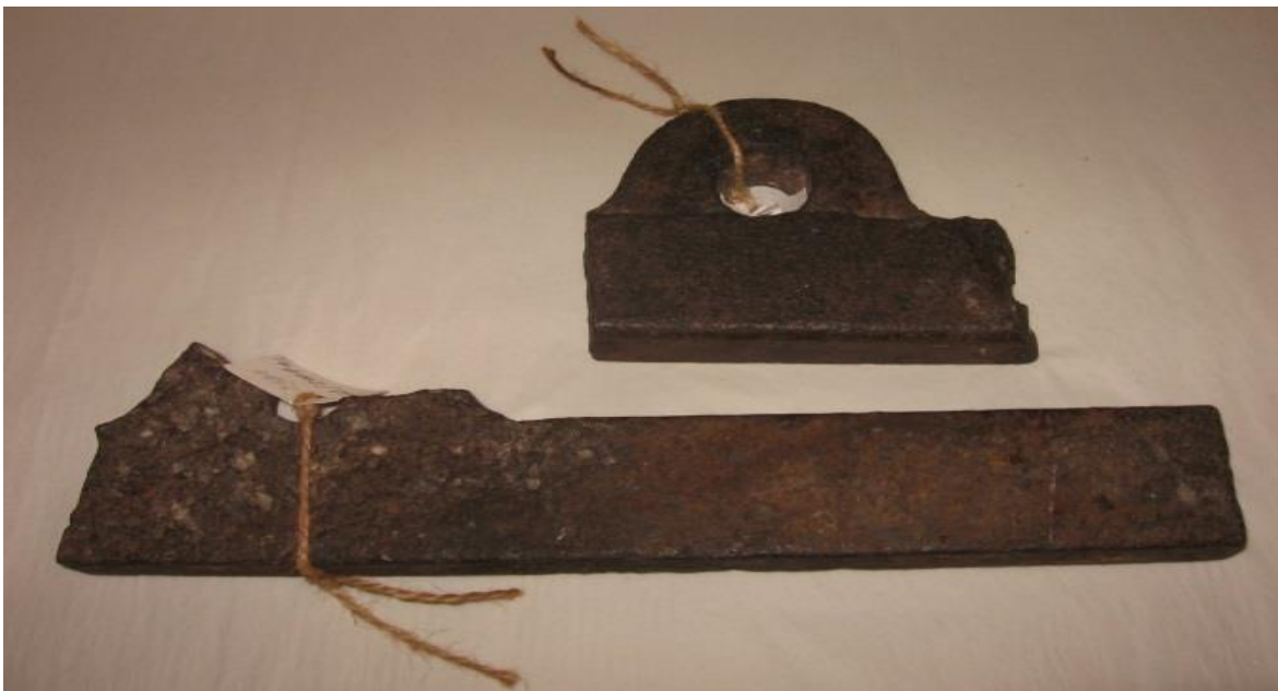
Obr. 319 Zlomky původních plochých litinových kolejnic z koněspřežné železnice Praha - Lány
