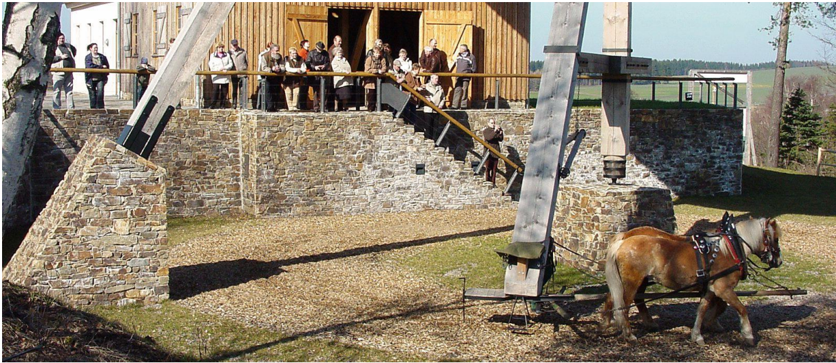
Obr.448 Rekonstruovaný žentour s těžním strojem – Marienberg (Sasko) – Krušné hory – Rudolfschacht (Obr. 446 až 448 z www.marienberg.de )
