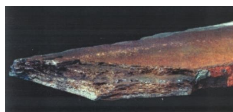
Obr.34 Struktura svářkového železa
