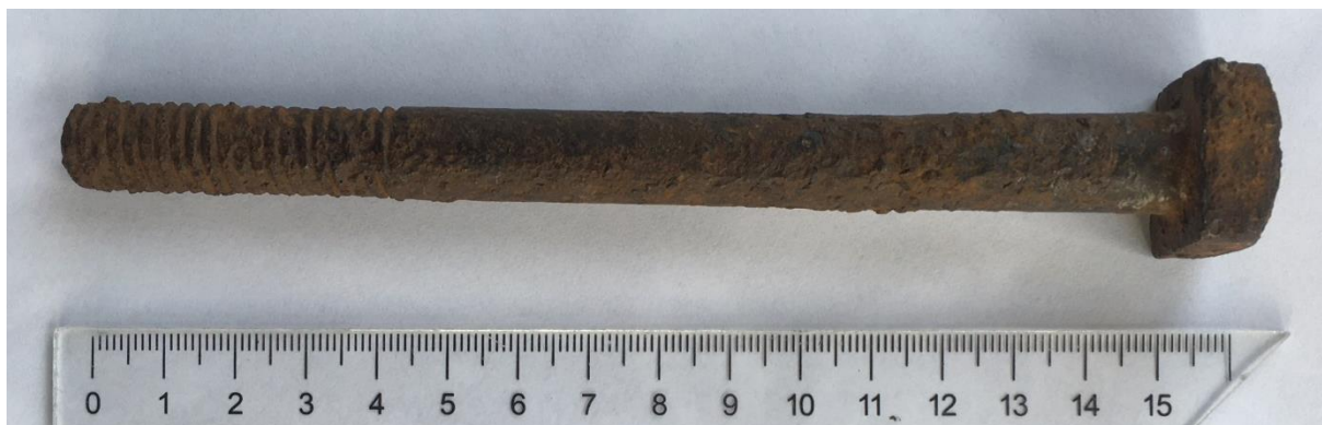
Obr.56 Očištěný železný šroub se čtyřhrannou hlavou a dobře viditelnými závit
