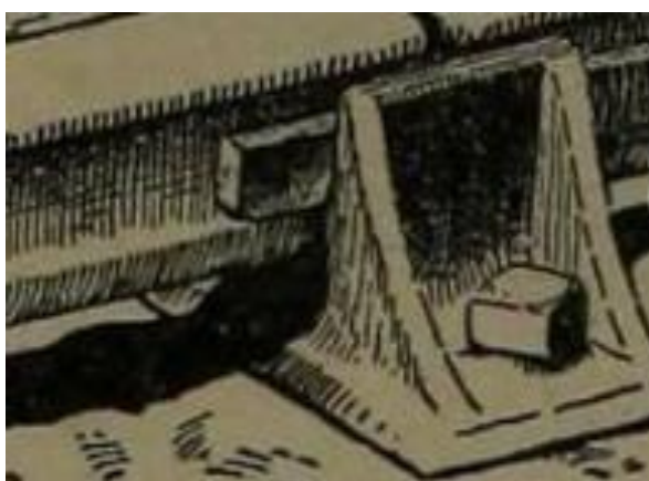
Obr.154 Detail upevnění kolejnice klínem
