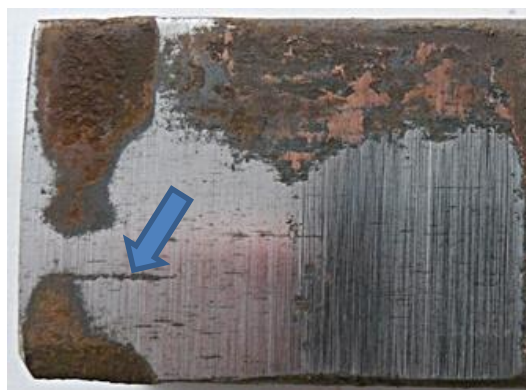
Obr.10 Vadný svar ve svářkovém železe
