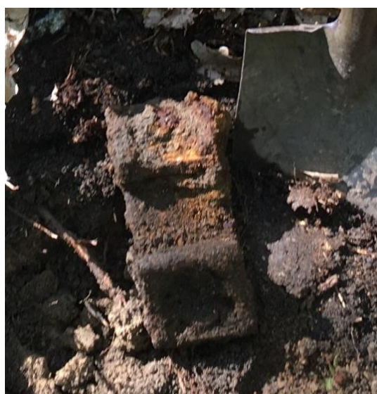
Obr.143 Litinová upevňovací stolička
