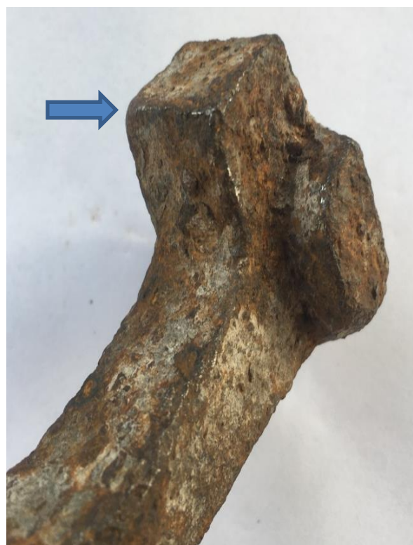
Obr.98 Hlava hřebu s „nosem“
