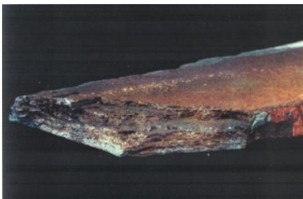
Obr.9 Vrstevnatý lom svářkového železa (Lit.52)
