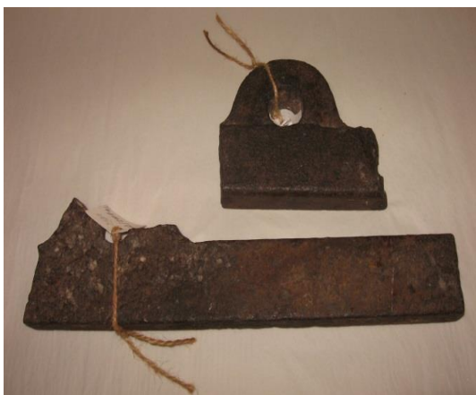
Obr.3 Zlomky původních litinových kolejnic
