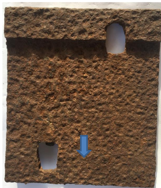
Obr.83 Podkladová deska - šířka vymačkání
