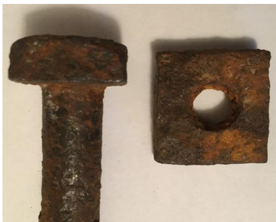
Obr.58 Železný šroub s maticí po očištění
