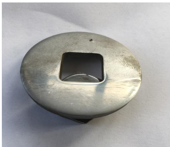
Obr.196 Velká podložka – broušena P2500
