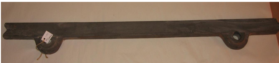
Obr.51 Kopie litinové kolejnice s nálitky opatřenými otvory k připevnění kolejnice hřeby ke kvádru
