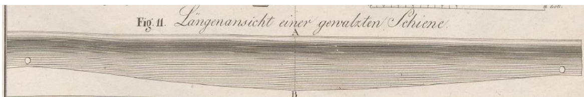
Obr.36 Válcovaná kolejnice proměnné výšky – nosník stejného napětí o délce 4-5 yardů (Lit. 1,4)
