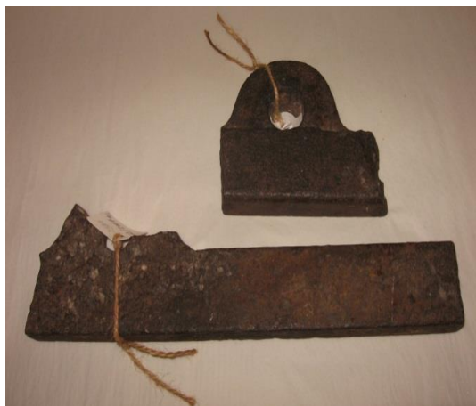
Obr. 45 Zlomky původních litinových kolejnic
