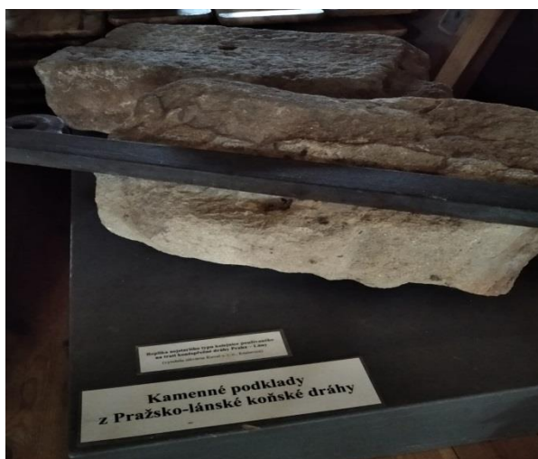
Obr. 50 Kvádr a kopie litinové kolejnice
