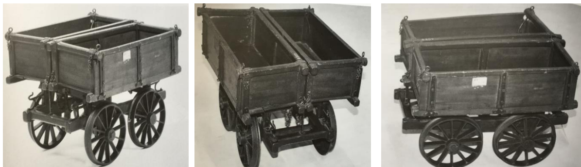
Obr.73,74,75 Model vozu k dopravě štěrku – autor Josef Božek r. 1826 , snímky převzaty z (Lit.54)
