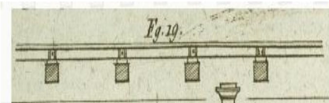
Obr.26 Kolejnice z kujného železa ve stoličkách
