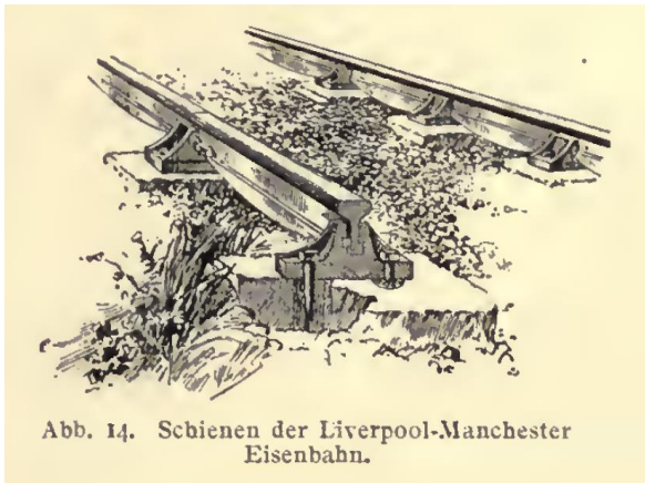
Obr.33 Kolejnice a stoličky z roku 1830 (Lit.11) Obr.34 Kolejnice a stoličky KFNB z roku 1837 (Lit.11)
