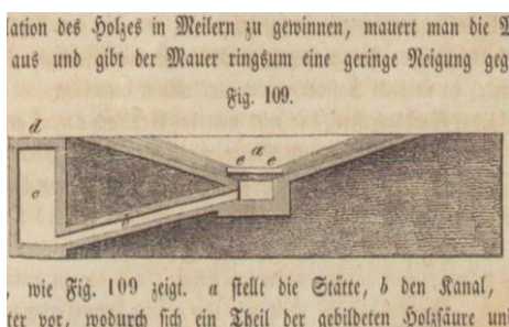
Obr.99 Sběr produktů destilace
