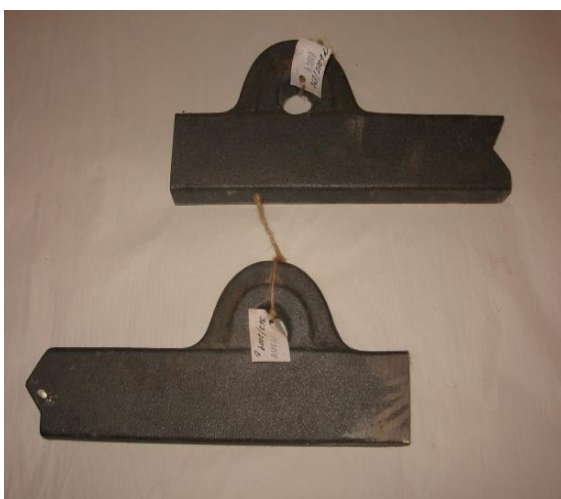
Obr.48 Kopie ploché litinové kolejnice
