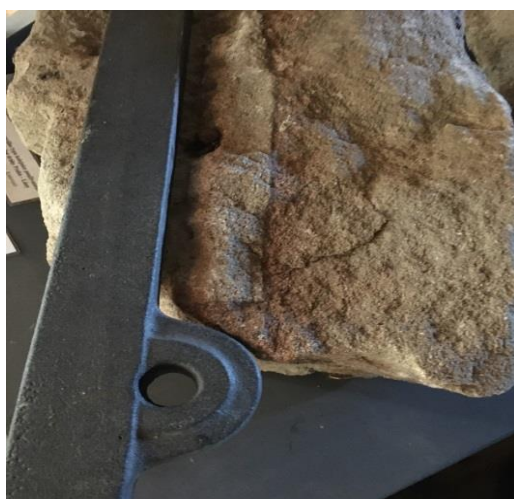
Obr.47 Kopie ploché litinové kolejnice
