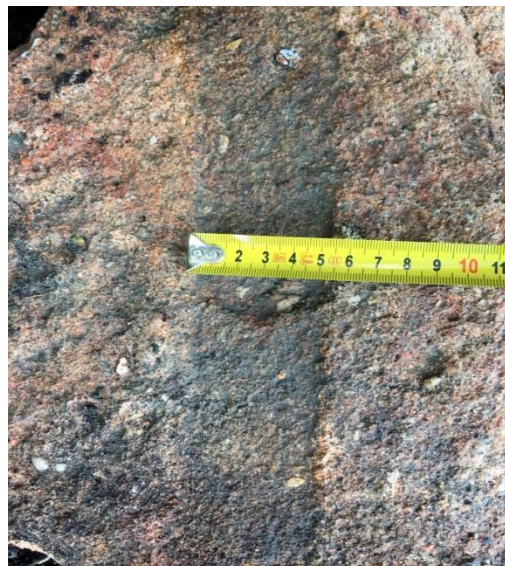
Obr. 335 Vydrolená stopa po kolejnici
