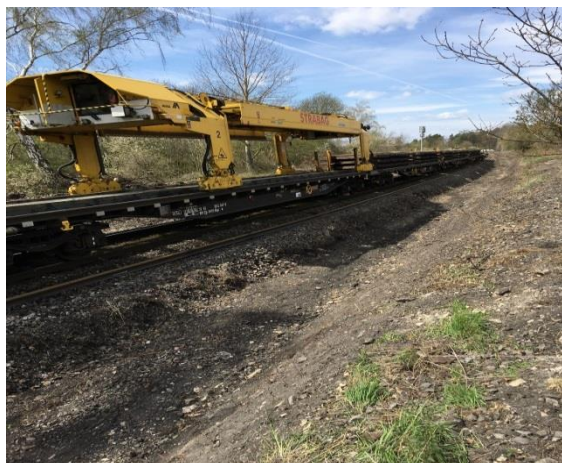
Obr. 487 Portálový pražcový manipulátor
