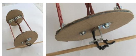
Obr.93,94 Uchycení špejle ke kolu
