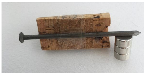
Obr.282 Magnetizace hřebíku pomocí magnetů
