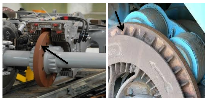
Obr.346,347 Indukční brzda vozidla
