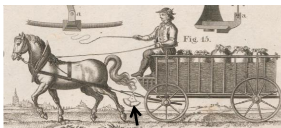
Obr.189 Pružinová váha k zjištění tažné síly koně
