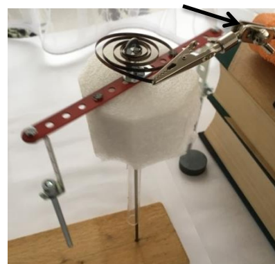
Obr.123 Torzní kmity setrvačníku
