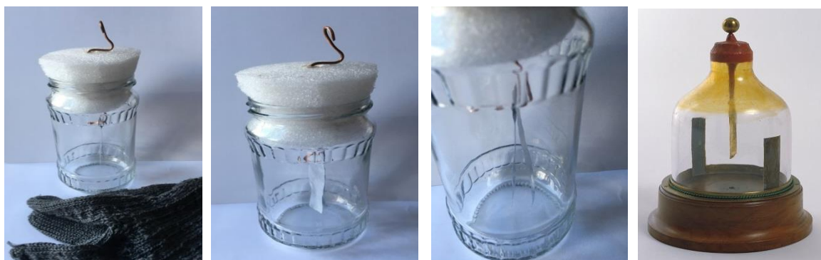
Obr.1028 Elektroskop Obr.1029 Plátky v klidu Obr.1030 Plátky nabity Obr.1031 Elektroskop
