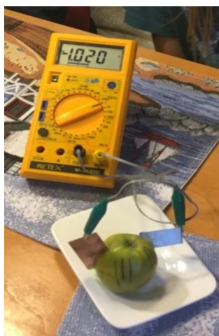
Obr.778 Napětí článku Zn-Cu Obr.779 Jablko funguje Obr.780 Ponoření jablka do roztoku
