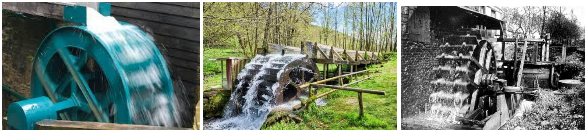
Obr.504 Kolo na horní vodu Obr.505 Vodní kolo na horní vodu Obr.506 Kolo na spodní vodu
