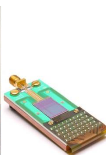
Obr.798 Sestava etalonu PTB 10V
