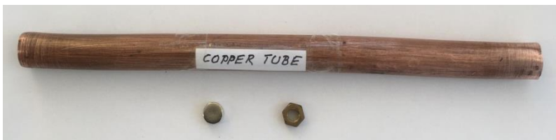
Obr.327 Měděná instalační trubka s magnetem a maticí
