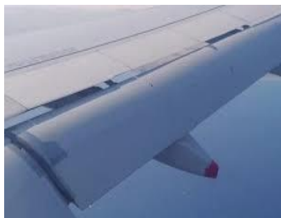
Obr.236 Vztlakové klapky křídla
