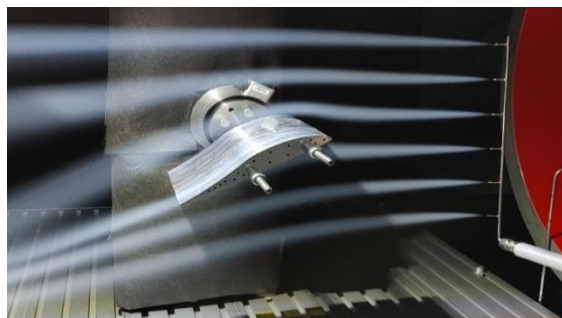
Obr.234 Zviditelnění proudnic pomocí proužků kouře Obr.235 Křídlo v oblasti největšího vztlaku
