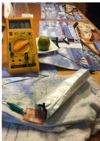
Obr.801,802,803 Zmrzlina v chřupavé trubičce posloužila jako elektrolyt
