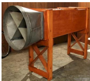
Obr.223 Váhy a zkušební tunel – Wright Brothers
