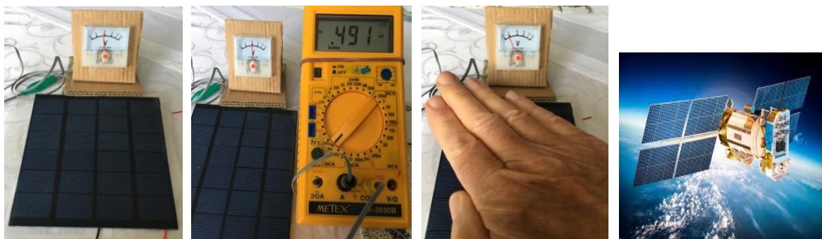
Obr.839 Solární panel Obr.840 Výkon panelu Obr.841 Napětí kleslo Obr.842 Napájení družice
