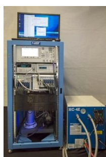
Obr.798 Sestava etalonu PTB 10V
