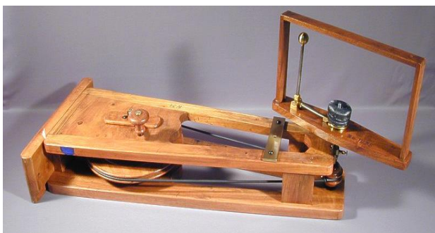
Obr.256 Školní přístroj pro dokázání odstředivé síly
