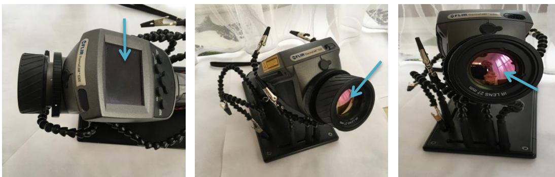
Obr.610 Kamera FLIR E301 Obr.611,612 Optika kamery nepropouští viditelné světlo
