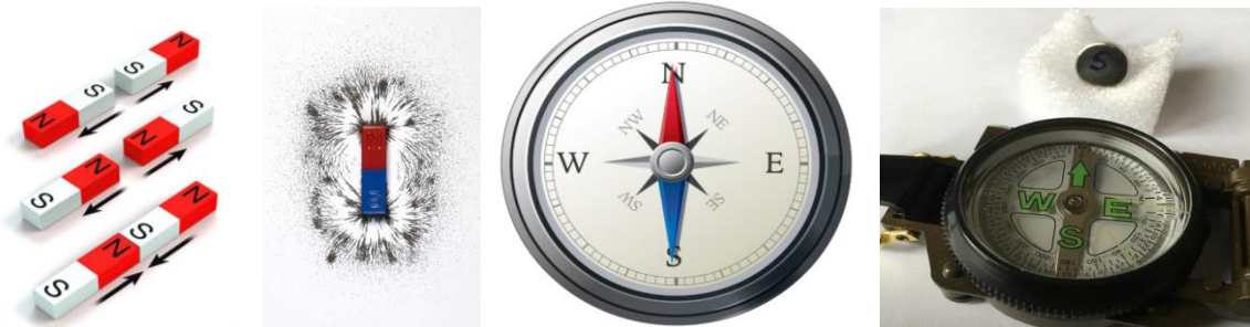
Obr.359 Severní a jižní póly magnetů Obr.360,361 Kompas ukazuje na sever (N červená barva )
