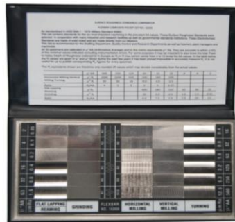
Obr.352 Vzorky drsnosti kovů
