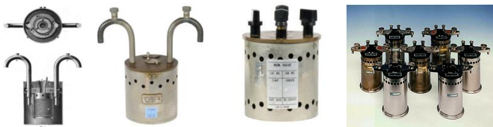
Obr.958,959 Odpor 1 Ohm z roku 1897 Obr.960 200 Ohm Obr.961 Sada odporů PTB
