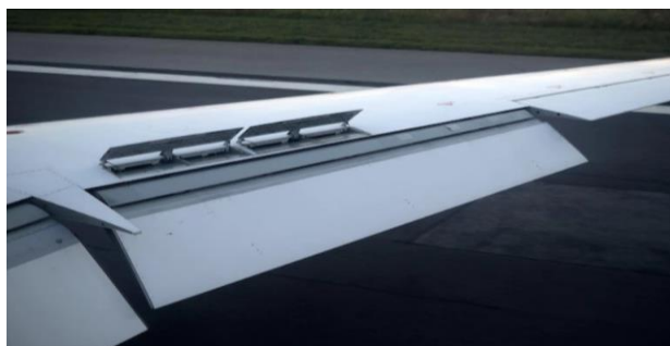
Obr.232 Vztlakové a brzdící klapky letadla
