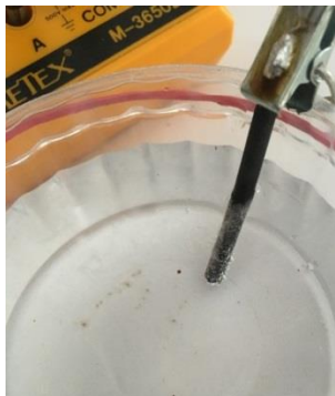
Obr.853,854 Rozklad vody pomocí baterie 5VDC
