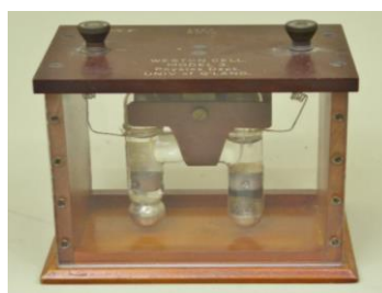
Obr.793,794 Laboratorní provedení Westonova článku
