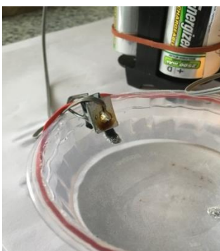
Obr.853,854 Rozklad vody pomocí baterie 5VDC
