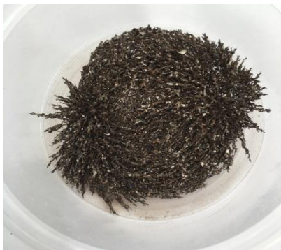
Obr.289 - 291 Prostorové upořádání ocelových třísek na kulovém magnetu
