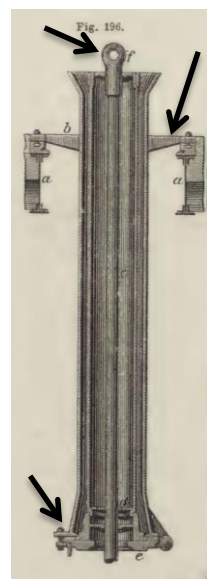
Obr.127 Slévárna litinového potrubí ve svislé poloze - stavba z roku 1873 (Lit.31) Obr.128 Forma
