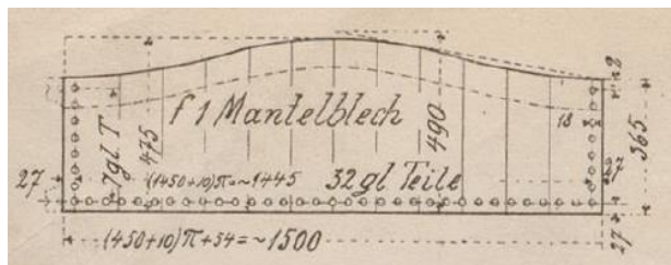
Obr.290 Výkres plechu před svinutím 1893 Obr.291 Výkres plechu s otvory pro nýty
