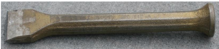
Obr.315 Tupý sekáč k utěsnění okraje kotlového plechu
