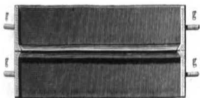
Obr.223 Litinové rámy formy spojené železnými kolíky
