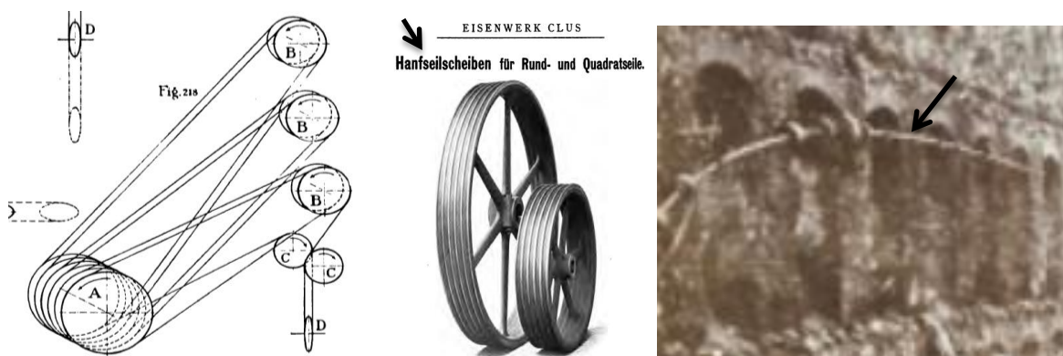
Obr.31 Náčrt lanového převodu Obr.32 Lanová kola r.1907 Obr.33 Transmise přádelny ve Slaném
