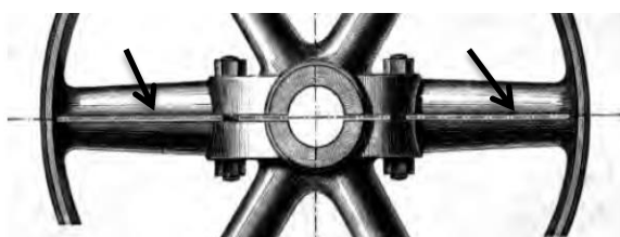
Obr.243 Řemenice složená ze dvou segmentů
