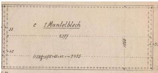
Obr.290 Výkres plechu před svinutím 1893 Obr.291 Výkres plechu s otvory pro nýty
