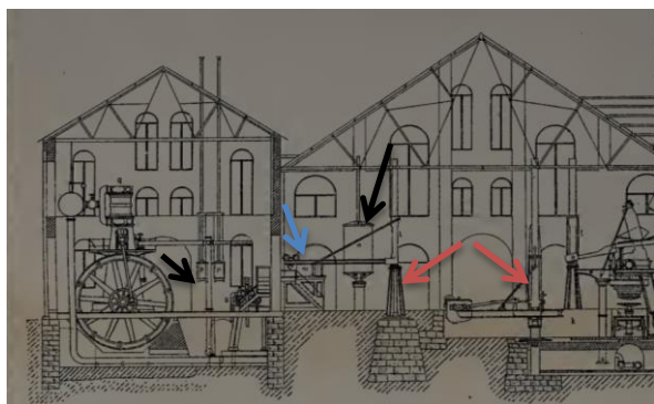
Obr.170 Konvertorová ocelárna v USA (Lit.13)
