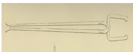
Obr.95 kleště k obracení balíku
