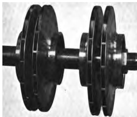
Obr.58 Snímek oběžných kol čerpadla
