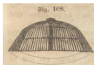
Obr.5 Milíř na základu
